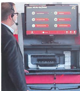
PULPIT OPERATORA MOŻNA ZASTĄPIĆ PILOTEM LUB WŁĄCZYĆ TRYB DIAGNOZOWANIA
